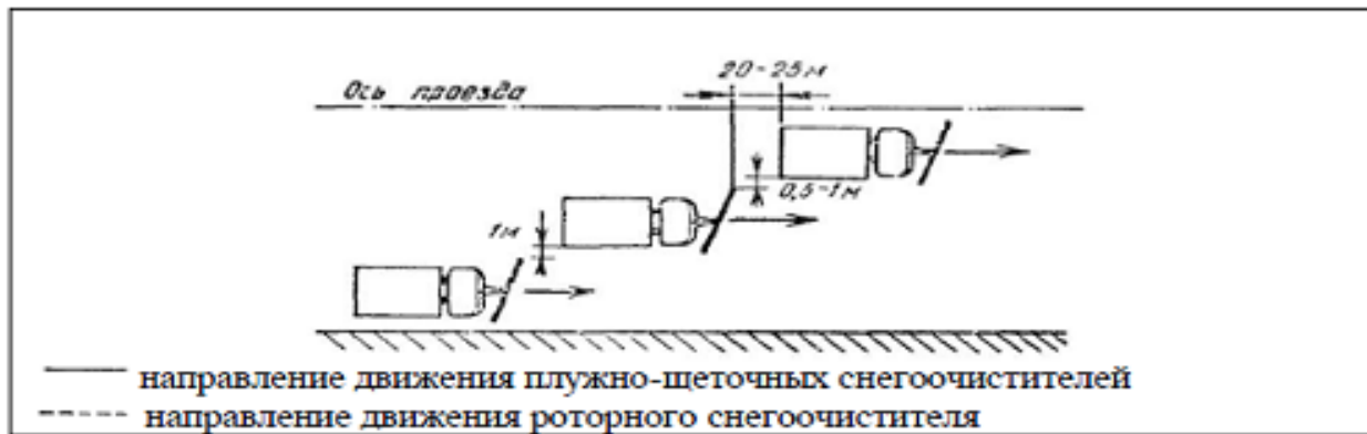
Рисунок 8 – Схема расчистки проезжей части улиц колонной плужно-щеточных снегоочистителей и складирование снега в лотке.
