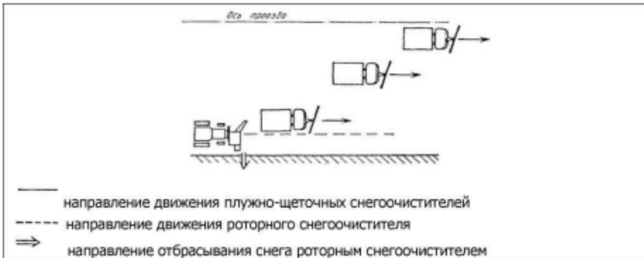
Рисунок 9 – схема расчистки проезжей части улиц колонной плужно-щеточных снегоочистителей и перекидывание снега роторным снегоочистителем.
